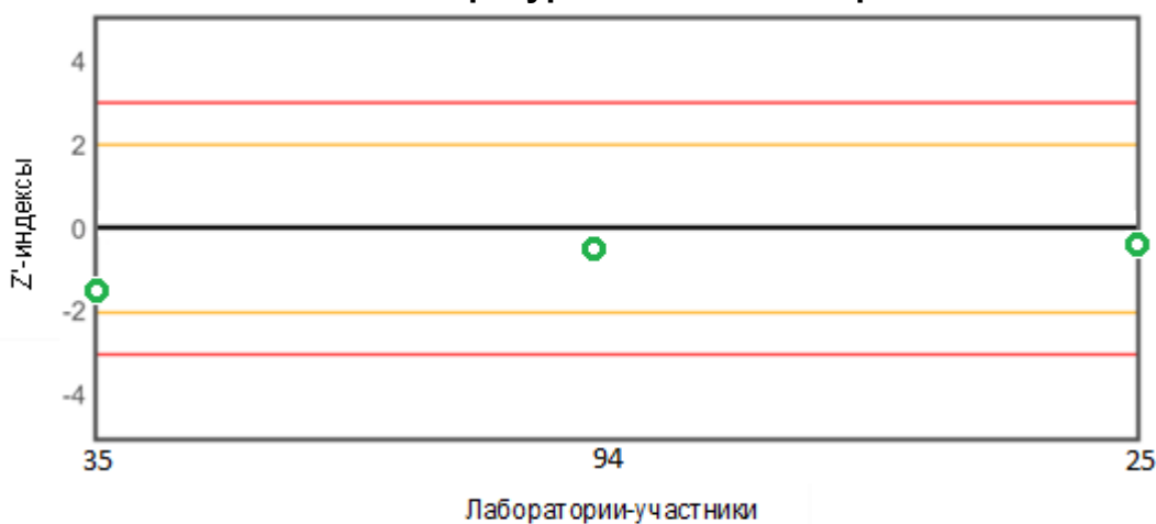
Рис. 6 Распределение z'-индексов для показателя «Температура вспышки в открытом тигле»
