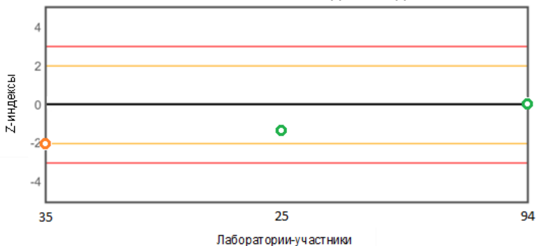
Рис. 2 Распределение z-индексов для показателя «Массовая доля воды»
