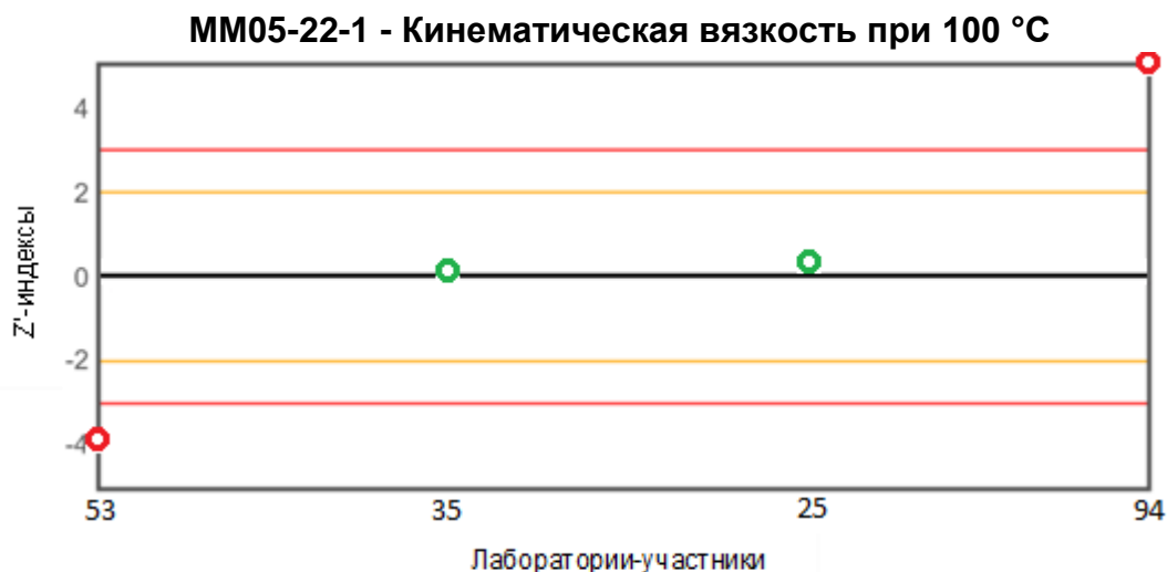
Рис. 4 Распределение z'-индексов для показателя «Кинематическая вязкость при 100 °С»
